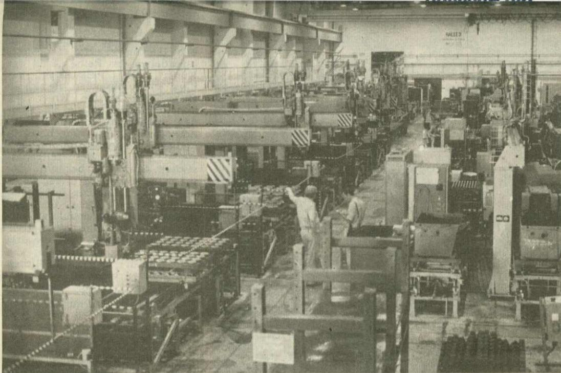
Blick in die „Fabrik der Zukunft“. Sechzehn Bearbeitungszentren mit Beschickungsrobotern erhöhen den Automatisierungsgrad bei der Bearbeitung von Motorteilen auf 95 Prozent.
